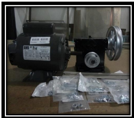
Ilustración 7 Motorreductor de velocidad, pernos.
