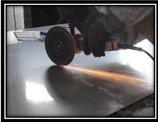
Ilustración 1 Corte de plancha de acero inoxidable.
