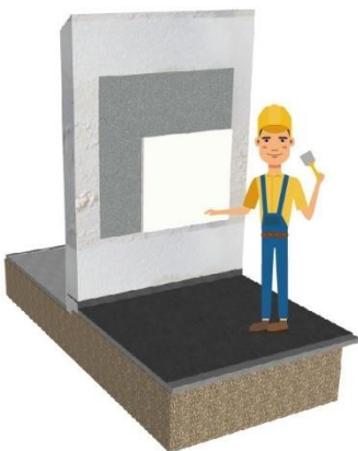
Figura 63. Solución al problema de humedad cambio de revoque
