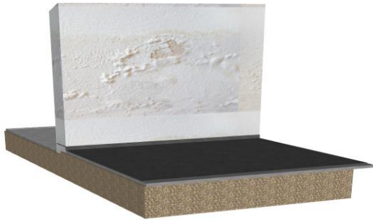
Figura 62. Problemas de humedad en muros eflorescencia
