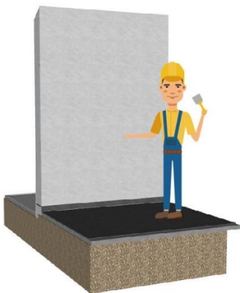
Figura 60. Solución a la patología (revoque de mortero)
